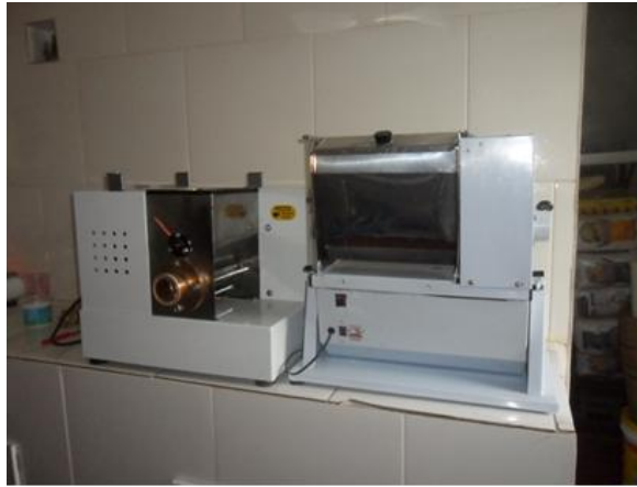
Figura 04- Extrusora (à esquerda) e amassadeira industrial (à direita) da agroindústria Sabor Italiano, São José do Ouro, 2013.
