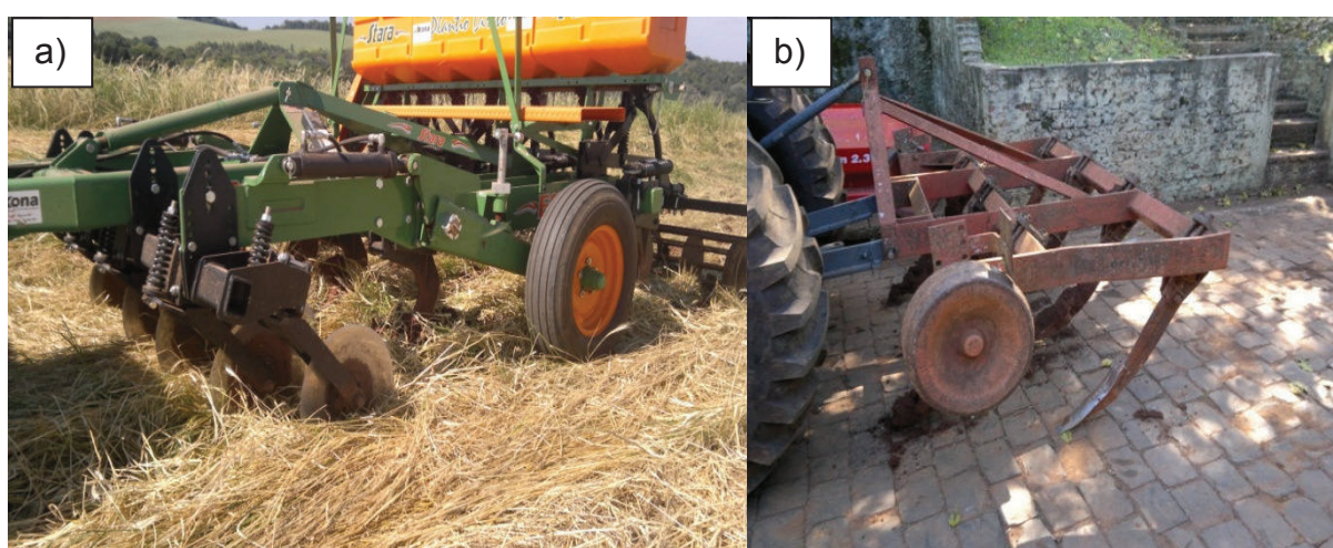
Figura 1. a) Subsolador dotado de disco de corte de palha e rolo nivelador; b) Subsolador convencional.
